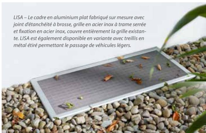
LISA – Le cadre en aluminium plat fabriqué sur mesure avec joint d'étanchéité à brosse, grille en acier inox à trame serrée et fixation en acier inox, couvre entièrement la grille existante. LISA est également disponible en variante avec treillis en métal étiré permettant le passage de véhicules légers.
